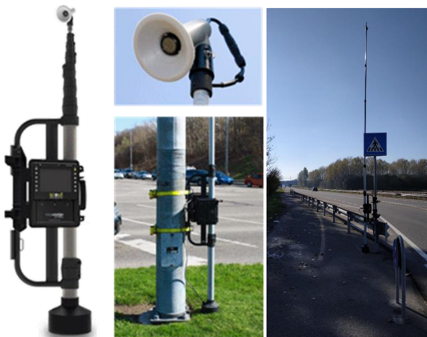
Figura 15 – Strumentazione video con palo telescopico
