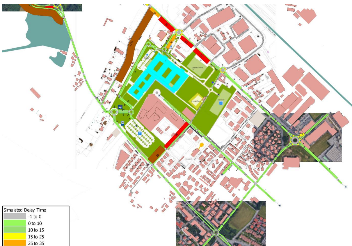
Figura 78 – Scenario di progetto “cautelativo”: perditempo medio veicolare rete stradale area di studio
