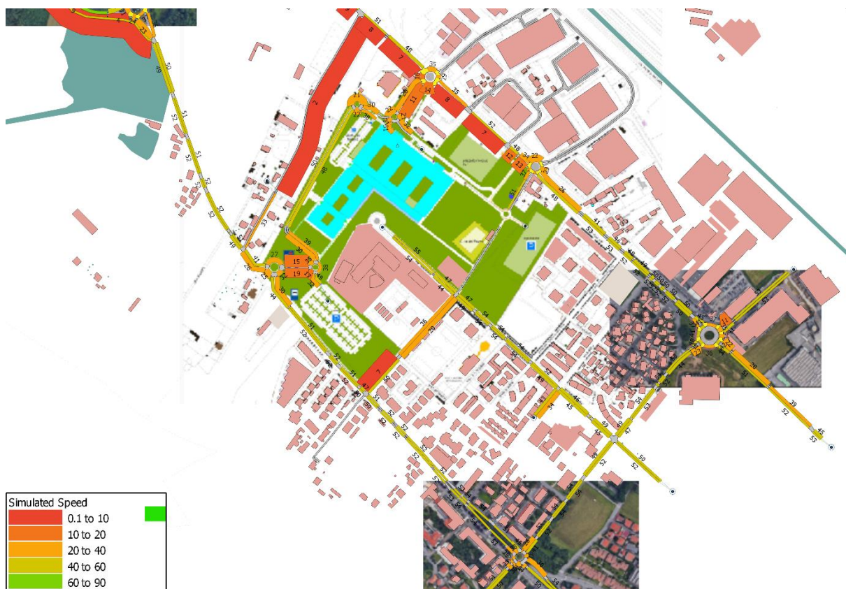
Figura 79 – Scenario di progetto “cautelativo”: velocità media veicolare rete stradale area di studio
