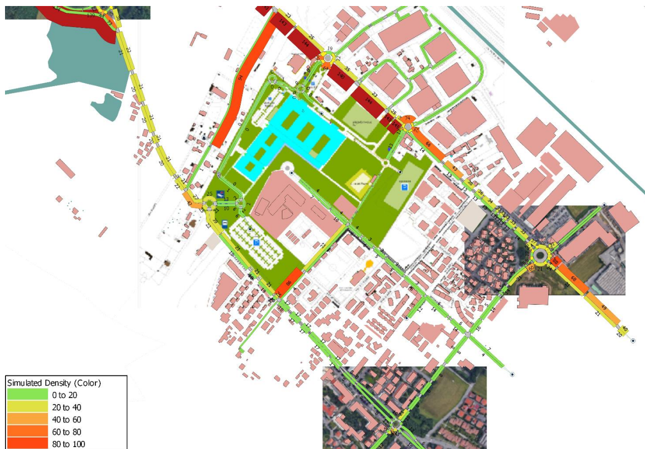
Figura 80 – Scenario di progetto “cautelativo”: densità veicolare rete stradale area di studio
