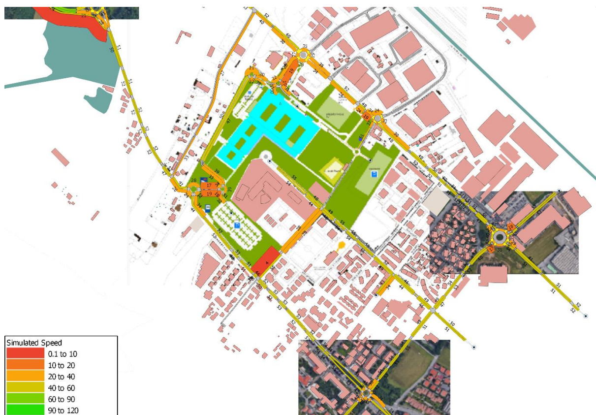
Figura 91 – Scenario di progetto “tendenziale”: velocità media veicolare rete stradale area di studio
