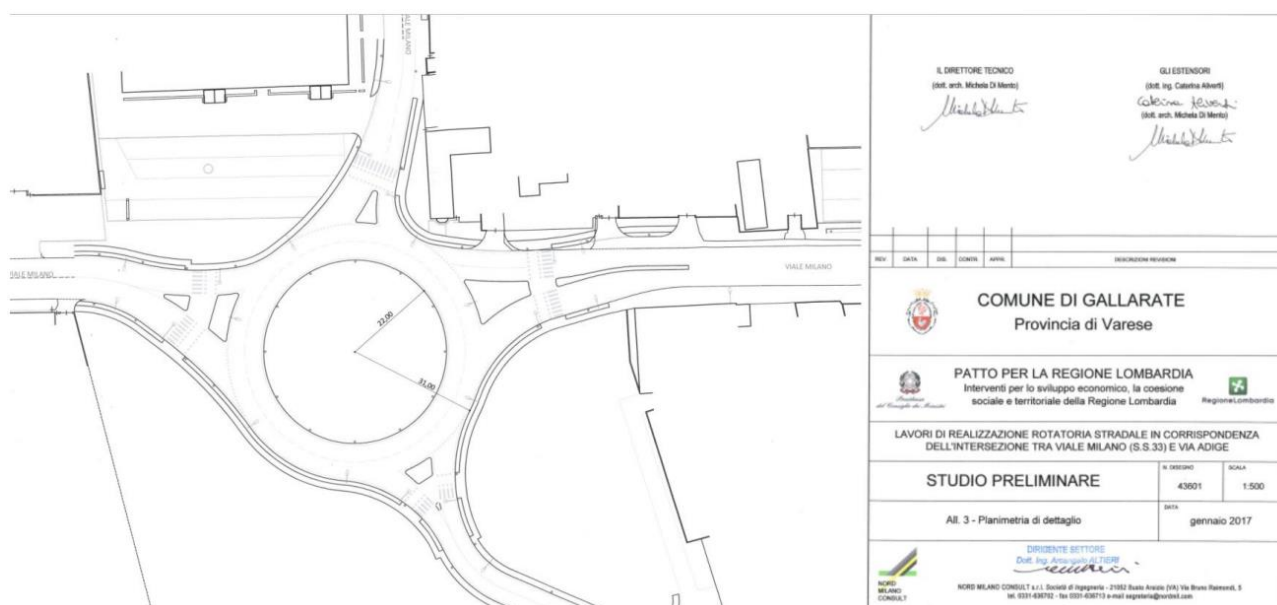
Figura 57 – Nuova rotatoria sulla Via Milano in prossimità dell'intersezione con via Adige
