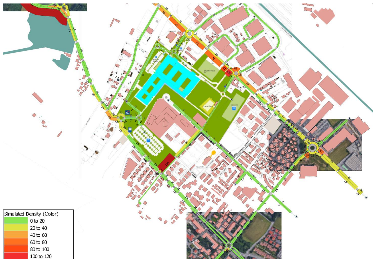
Figura 92 – Scenario tendenziale di progetto: densità veicolare rete stradale area di studio
