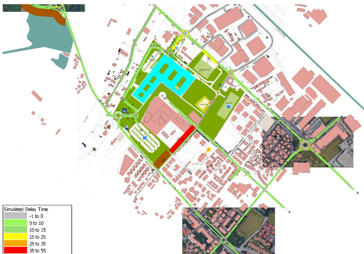
Figura 90 – Scenario di progetto “tendenziale”: perditempo medio veicolare rete stradale area di studio
